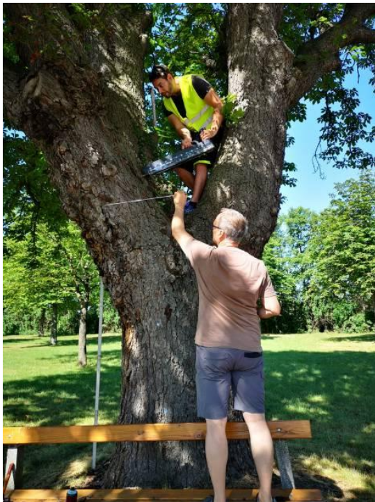
Abbildung 17: (links) Bohrwiderstandsmessung am Stammkopf und (rechts) Stamm (Eigene Darstellungen)
