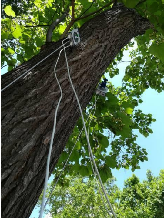
Abbildung 19: (links u. rechts) Sensoren für die Dehnungsmessung am Stamm; (rechts) Sensor für die Neigungsmessung am Stammfuß (Eigene Darstellungen)
