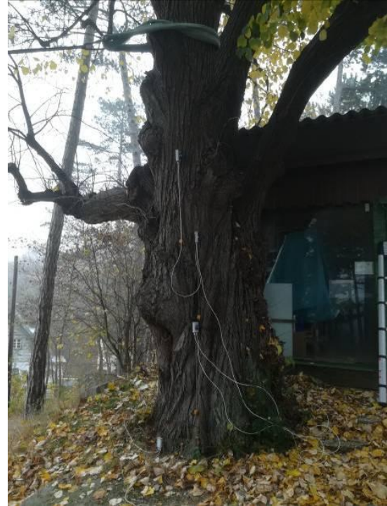
Abbildung 19: (links u. rechts) Sensoren für die Dehnungsmessung am Stamm; (rechts) Sensor für die Neigungsmessung am Stammfuß (Eigene Darstellungen)
