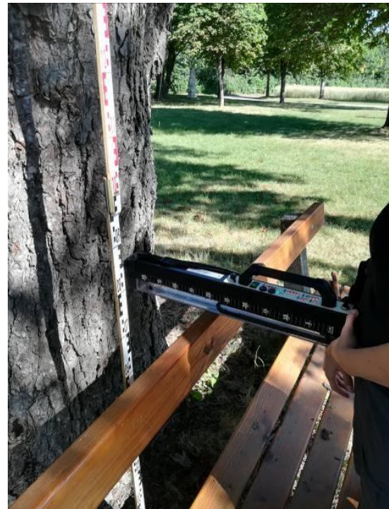
Abbildung 17: (links) Bohrwiderstandsmessung am Stammkopf und (rechts) Stamm (Eigene Darstellungen)
