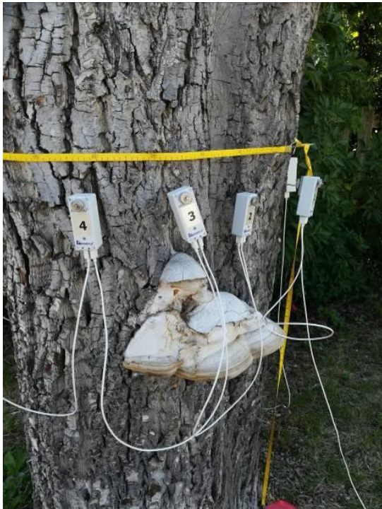
Abbildung 18: (links) Sensoren des Schalltomographen; (rechts) farbiges 2-D Computermodell des Stammquerschnittes (Eigene Darstellungen)
